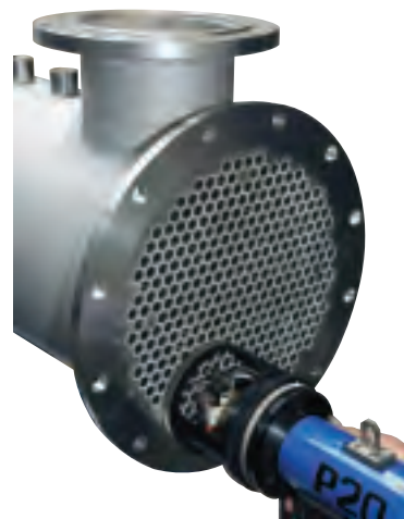
Saldatura automatica dei terminali delle tubazioni e ispezione al 100%
